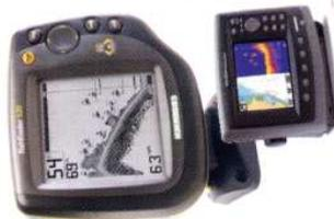
**MATRIX-Serie:** Fischfinder mit hochauflösenden Anzeigen (bis 640 x 320 Bildpunkte) mit 12 Graustufen oder Farbanzeigen, Geber mit einem, zwei oder vier Sendekegeln, erweiterbar mit Baroskop, GPS oder SMARTCAST Geber, PC-Anschluss. Auch als portable Modelle oder als **Kombigerät** mit GPS, Seekartenplotter und Fischfinder erhältlich.
